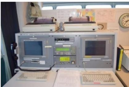
ブリッジ左舷側後部に設置されているGMDSSコンソール(GMDSS COMMUNICATION CONSOLE)。遭難通報や、気象情報等海上安全情報を受信する装置で、1999年より設置が義務付けられている。情報を印刷することもできる。研修の際、台風16号が台湾に近づいていたが、その天気図が印刷されブリッジに置かれていた。
