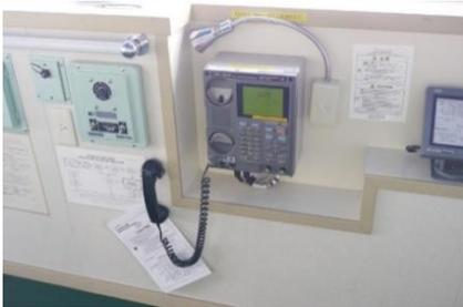
ECDIS等の隣に位置するMARINE VHF RADIOTELEPHONE(国際VHF無線電話装置)。GMDSS(GLOBAL MARITIME DISTRESS AND SAFETY SYSTEM=海上における遭難及び安全に関する世界的な制度)対象船舶に搭載義務のある無線装置。港湾への入出港時に近距離の船舶や海岸局と連絡する際や、他船との安全確認の為に使われている。
