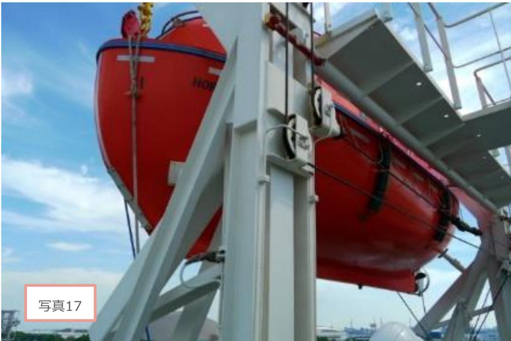
写真17は上甲板の船側に設置されている救命ボート、写真18海に投げ込むと内部のゴムで作られている内部のいかがが広がり円錐形になる膨張式救命いかだ、そして写真19は救命ボートの前面の上甲板に描かれている点呼のための集合場(=MUSTER STATION)である。MUSTER STATIONには、黄色の丸印の中に船員の方々の役職名が書かれている。万一の際には乗組員が集合したときに点呼が容易であるこちらで点呼が終了した後、救命ボートに乗り、避難をするそうだ。
