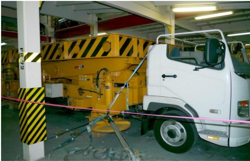
こちらが、そのある緑丸の印の隣に置かれていたもの—上部が切り取られたトラクタートレーラーと上下方向に伸縮する装置—である。こちらの車両と緑丸、どのような関連があるのかということは、この本船のデッキ及びホールドの構造を知っておくべきだろう。こちらは自動車船(PCC=PURE CAR CARRIER)ということで、様々な寸法の車両が積載される。しかし、デッキの高さが一定であると、様々なサイズの需要に対応しきれなくなる。そこで、設置されたのが、リフトブルデッキ(LIFTABLE DECK)である。本船のデッキの内、数デッキがリフトブルデッキであり、そのデッキが各々30数枚にパネルの様に分割されている。写真23をよく見て頂くと、奥や左側のパネル
