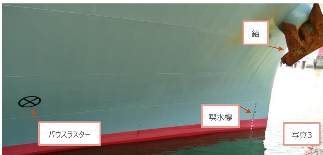
ろした貨物の量を知ることができる。ちなみに、喫水標は船首だけでなく、中央、船尾の左右舷に刻印されている。そのため、前後左右で喫水の高さが異なると、貨物の配置バランスがわかり、バランスが悪いとそれに応じて貨物を移動させたりする。
