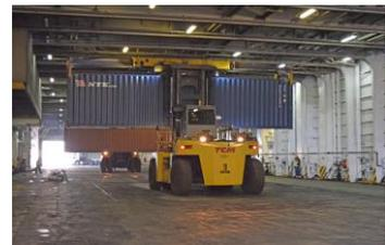
あらかじめ船倉にはトレーラーからコンテナを降ろすための大きなフォークリフトが待機しており、テンポよく作業がすすめられていく。一見、単純な流れ作業のようにみえるが、一步間違えれば、大きな事故につながる作業であるがため、高度のスキルが求められるのである。
